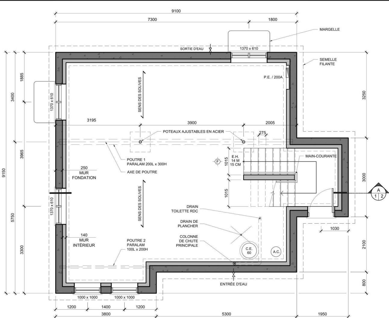
**PLAN DE CONSTRUCTION / SOUS-SOL**
